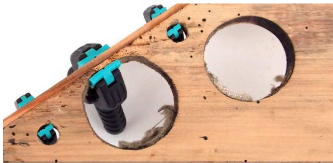
Obr. č. 46: Zosilnenie steny lavičky Cello C - strany.
