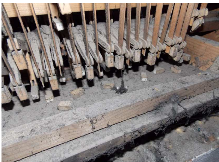
Obr. 20: Pohľad na časť traktúr v hracom stole pred reštaurovaním, vidno i odpadnuté „dorazy“ abstraktov.
