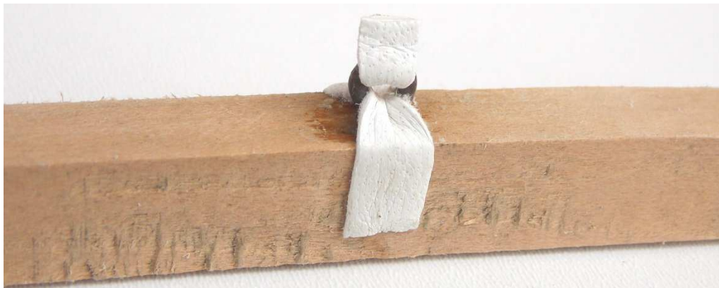
Obr. 2: Detail kožovania kovového oka jednoramennej páky - stav po reštaurovaní.
