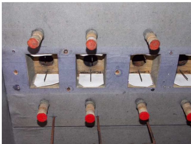
Obr. 7: Pohľad do „komôr“ transmisie Gedackt / Gemshorn so spätnými ventilmi a ich „dorazmi“ v otvorenej polohe - stav po reštaurovaní.
