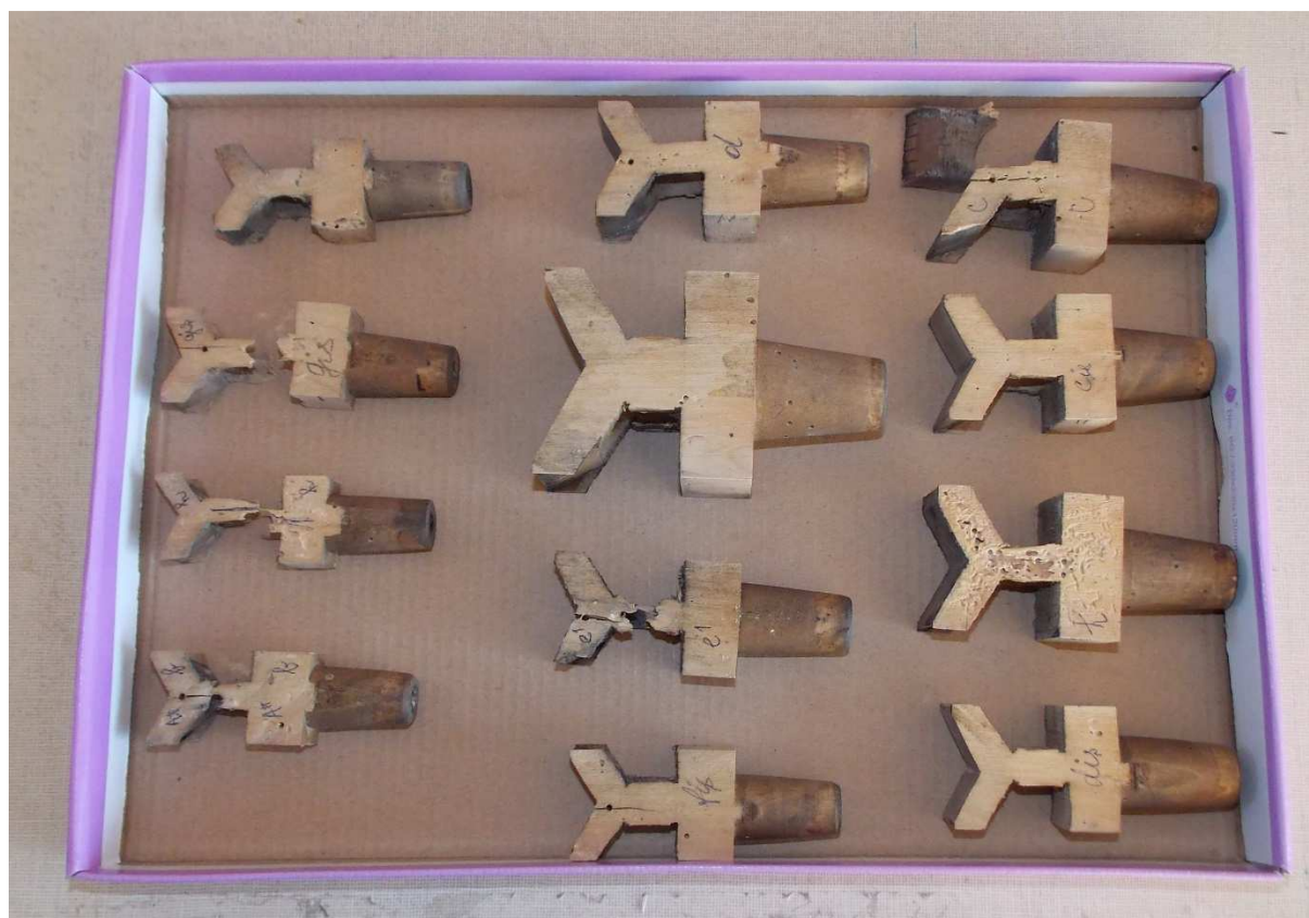
Obr. č. 49: Jadrá diskantových píšťal registra Gedackt 8'.
