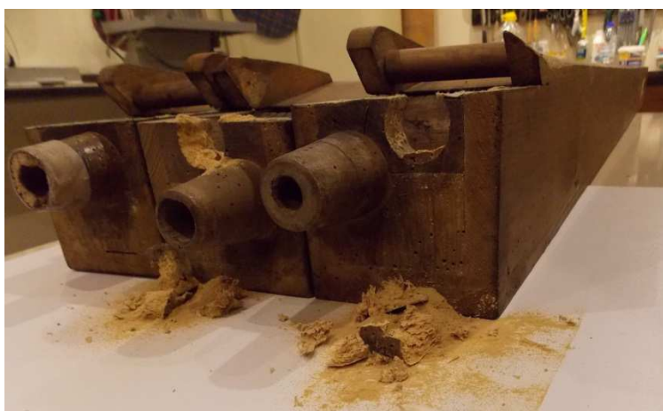
Obr. č. 48: „Plomby“ na dolných stranách jadier píšťal Principalu 8'.
