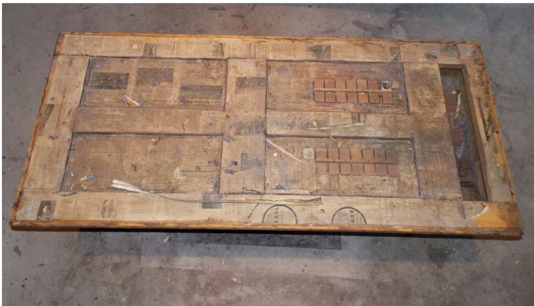
Obr. č. 29: Spodná doska mechu po demontáži faldov, vidno Neusserovo „tesnenie“ novinovým papierom.
