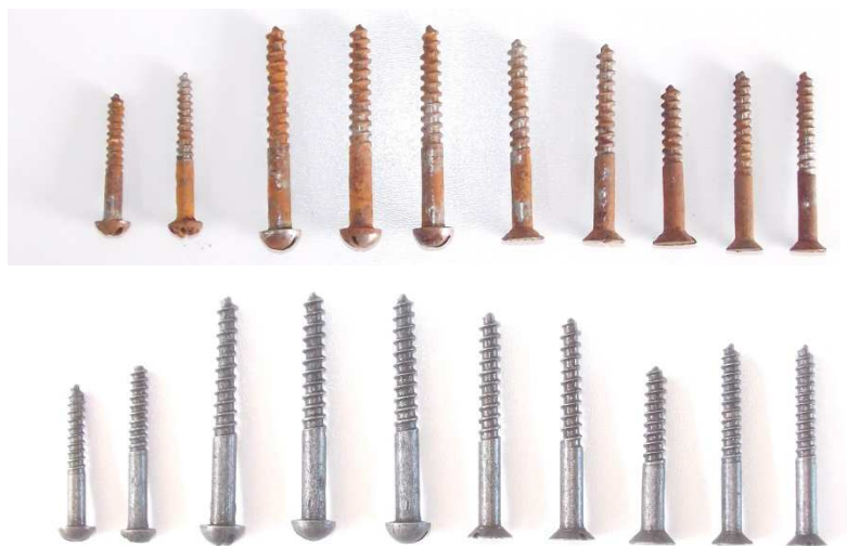
Obr. 24: Pôvodné skrutky - výber typov - pred a po reštaurovaní.
