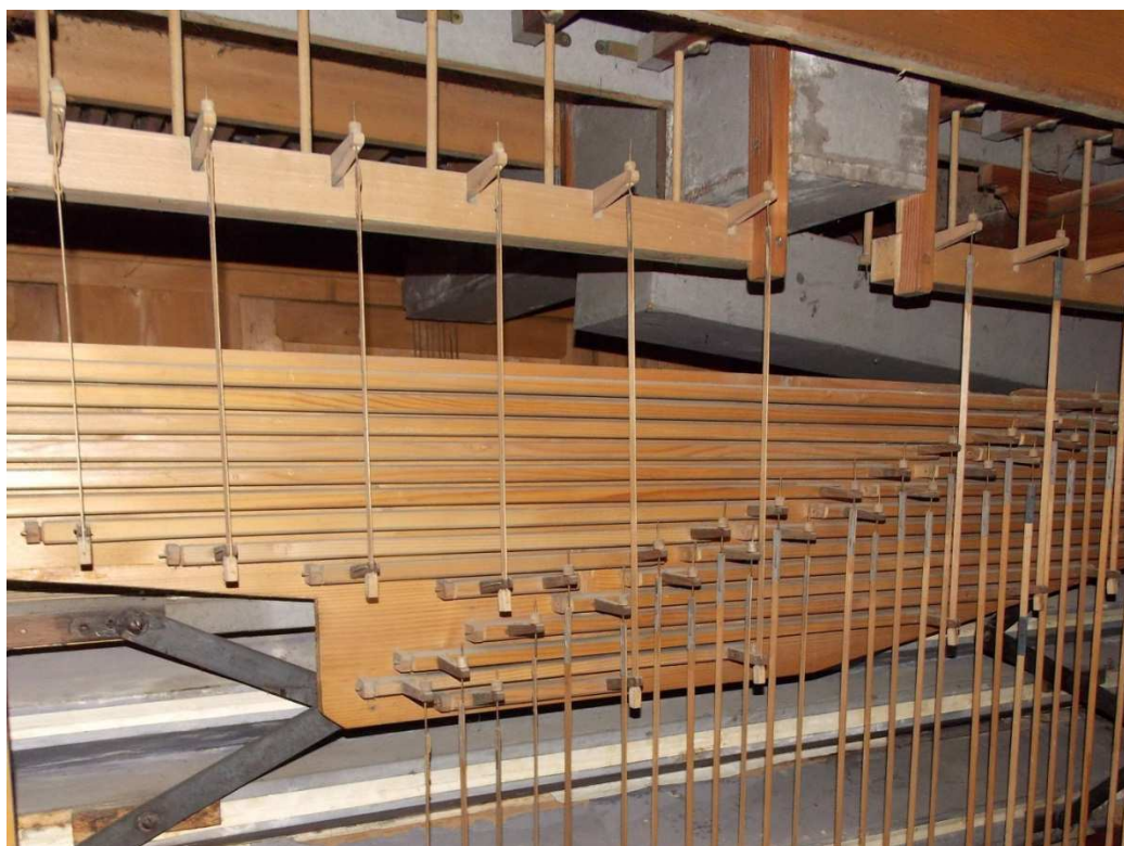
Obr. 3: Hriadeľová doska, nad ňou sústava dvojramenných pák pedálovej hracej traktúry - stav pred reštaurovaním.
