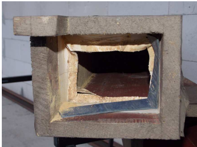
Obr. č. 34: Prilepené tesnenie zátky Subbasu16' - po náročnom odstránení drevenej časti zátky.
