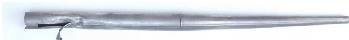
Obr. č. 54: Píšťala d 0 z registra Mixtur - III. rad počas reštaurovania. Deformáciu spôsobilo neodborné, až barbarské ladenie.
