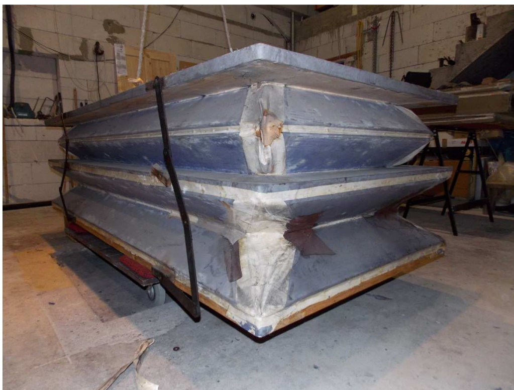
Obr. č. 38: Roztiahnutý zásobný mech pred očistením a odstránením kože a papiera.
