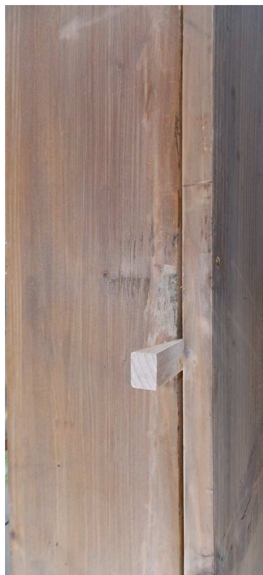
Obr. č. 35, 36: Rozglejené písťaly registra Subbas 16' vplyvom zatekania vody do nástroja.
