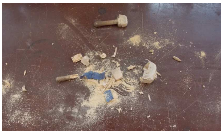
Obr. č. 47: Totálne deštruované zátky píšťal registra Gedackt 8'.
