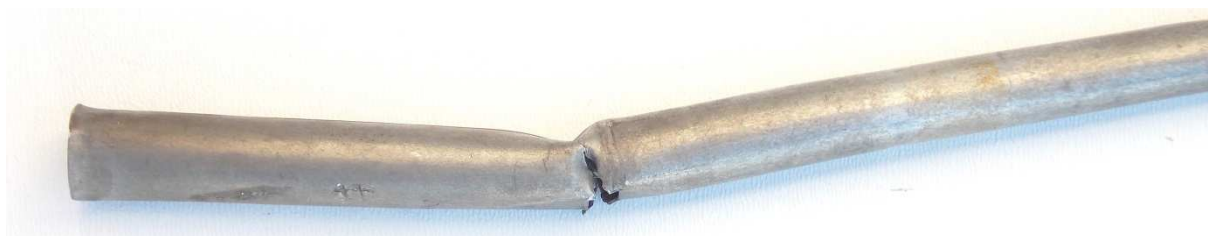
Obr. 56: Píšťala registra Mixtur dis 3 2´rad - silne poškodená tesne nad jadrom.
