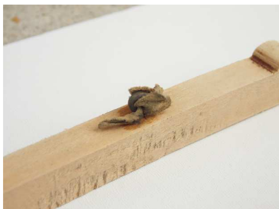
Obr. 22a, 22b: Okožovanie kovového oka jednoramennej páky hracej traktúry pred a po reštaurovaní.
