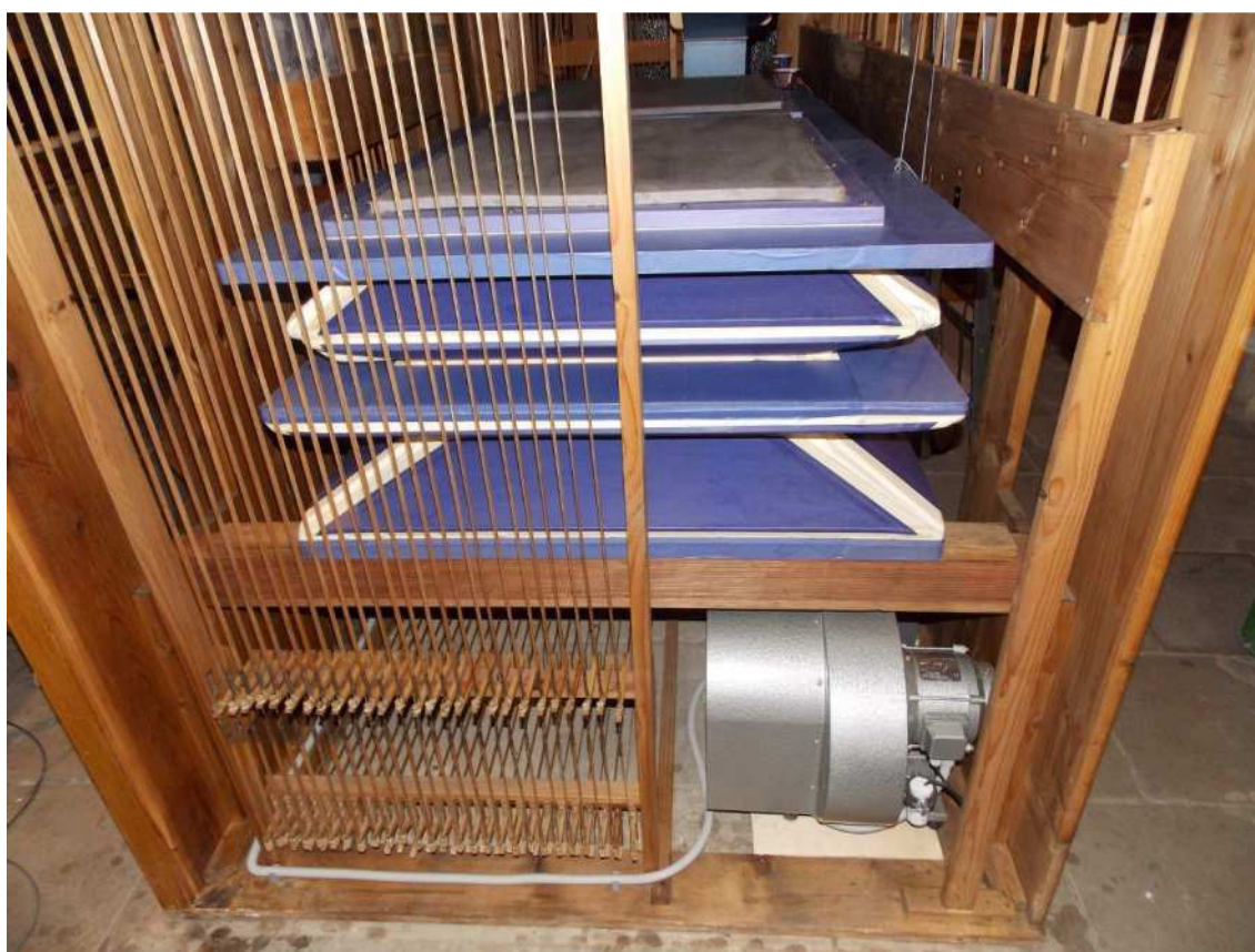
Obr. č. 25: Pohľad do sokla c-strany organa po reštaurovaní, pod mechmi je umiestnené čerpadlo vzduchu.
