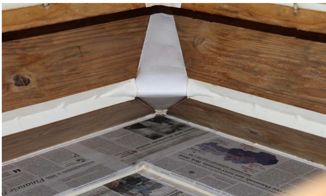
Obr. č. 40: Vnútorý roh zásobného mechu po reštaurovaní.
