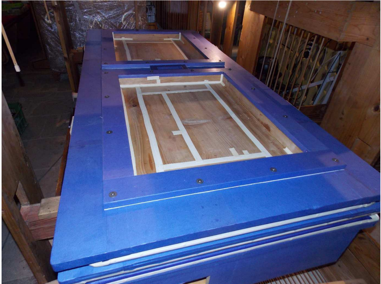
Obr. č. 41: Pohľad na zreštaurovaný mech v organe pred osadením tehlovej záťaže.
