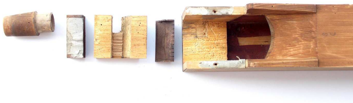
Obr. č. 50: Na „súčiastky“ rozpadnuté jadro píšťaly registra Gedackt 8'.
