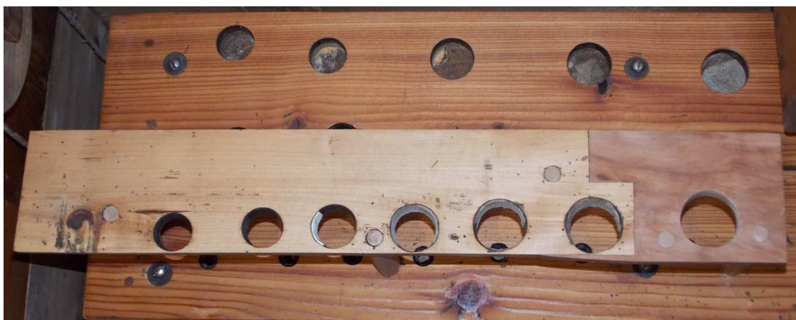
Obr. č. 45: Lavička cis strany registra Cello 8' po reštaurovaní- osadená na vzdušnici.
