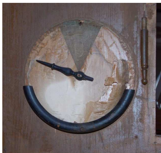
Obr. č. 58a, 58b: Ukazovateľ stavu mechu pred a po reštaurovaní.
