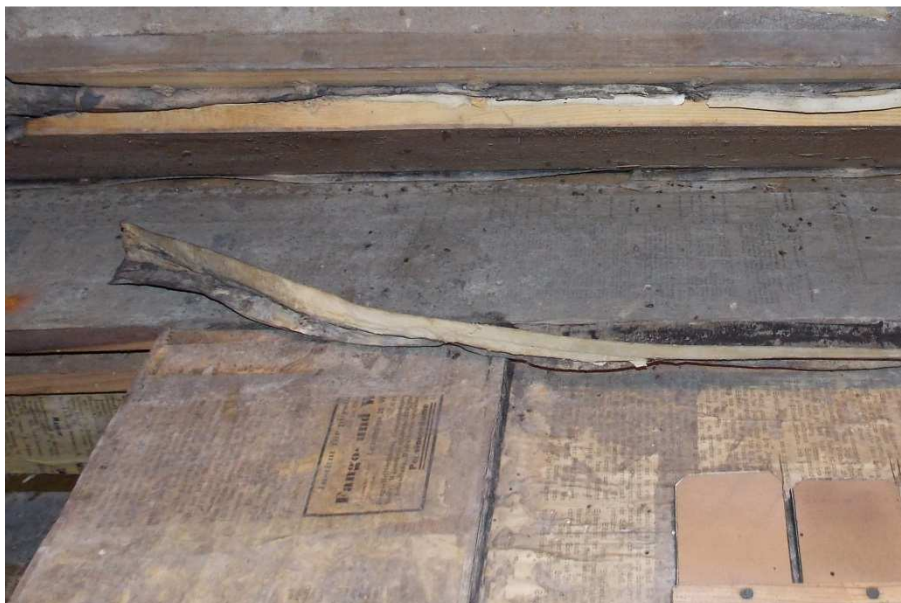
Obr. č. 31: Odlepený pás tesniacej kože v zásobnom mechu.
