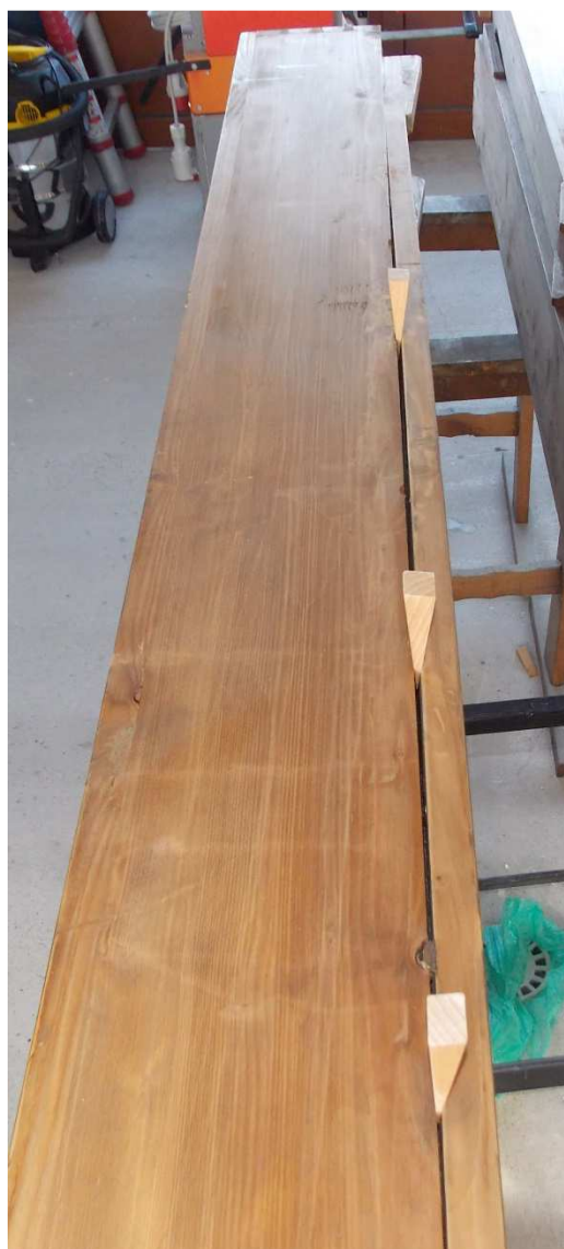
Obr. č. 35, 36: Rozglejené písťaly registra Subbas 16' vplyvom zatekania vody do nástroja.
