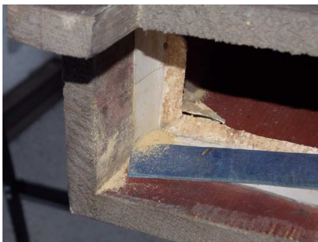
Obr. č. 51: Vnútro píšťaly registra Subbass 16' po vytiahnutí zátky.
